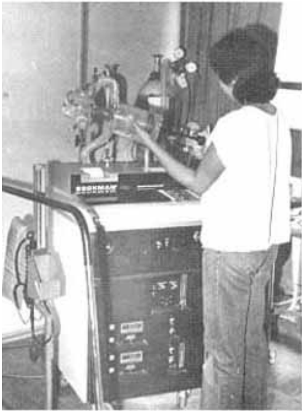
Fig. 1 - Com a utilização de um volume-padrão, empregando-se uma seringa, calibra-se a quantidade exata de ar na entrada do pneumotacógrafo.
