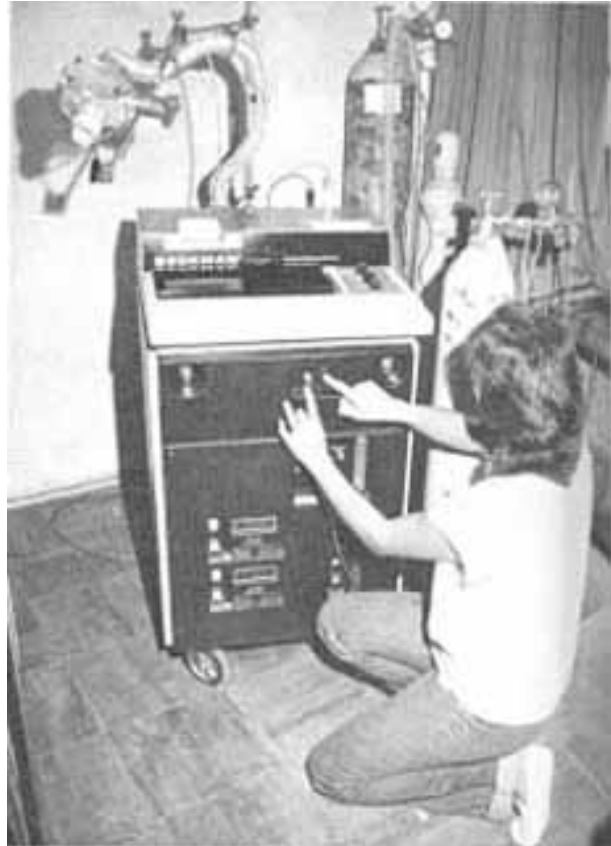
Fig. 2 - Com a utilização de torpedos com amostras conhecidas de CO_2 e O_2 procede-se à calibração dos gases após um período de aquecimento do equipamento. Retirada a amostra deverá ser lido no mostrador a concentração encontrada no ar atmosférico.
