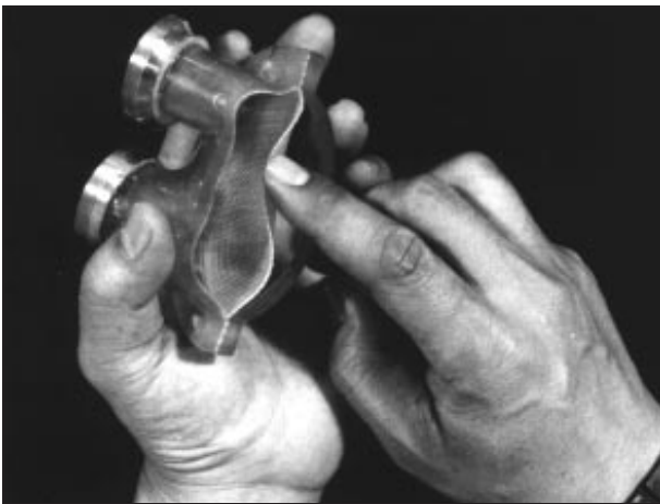
Fig. 2 - Membrana lisa de poliuretano, reforçada com tela de algodão separa a câmara de sangue da câmara pneumática.
